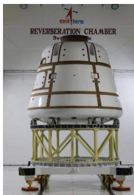
TV-D1 Ph-II Acoustic test
