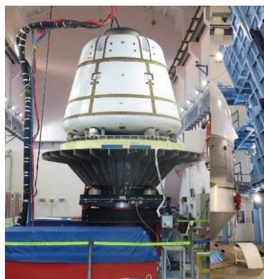
TV-D1 Ph-II Acoustic test
